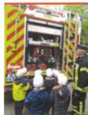
Hier hinten befindet sich die Pumpe und auch Anschlüssen für Schläuche! Wichtig ist: Roter Deckel kommt Wasser rein; grüner Deckel, kommt Wasser raus!
