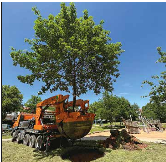
Neue Schattenspende am Spielplatz in der Gustav-Clauss-Anlage: Mit einem speziellen Ballenstecher wurden vier Bäume aufwendig verpflanzt. Bilder: Florian Jung
